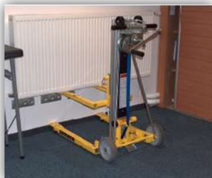
Pose / dépose d'un chauffage
